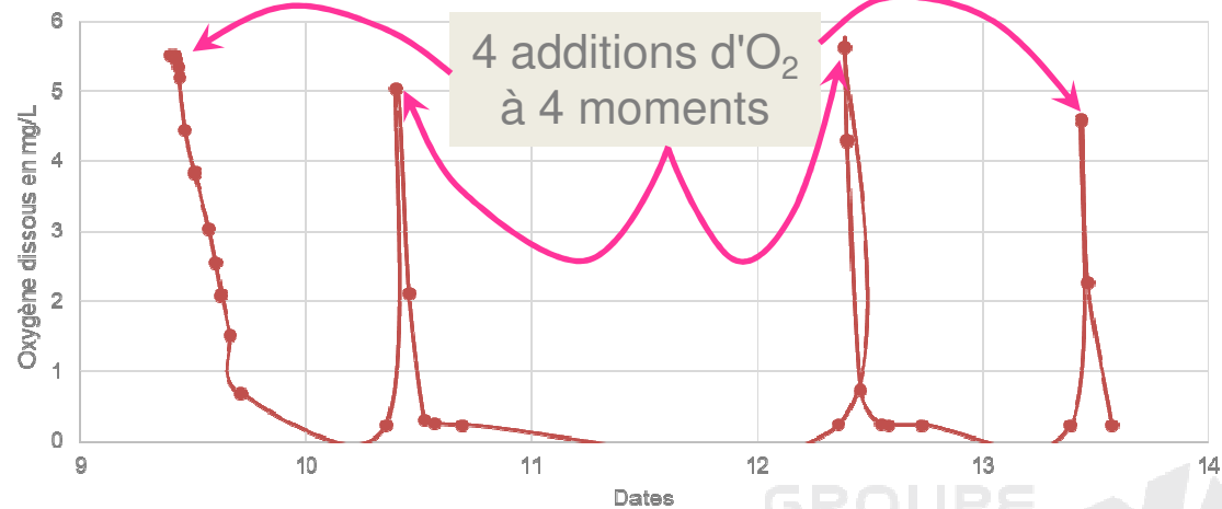
Oxygène dissous pendant la macération sur bourbes, après inoculation avec Initia®
